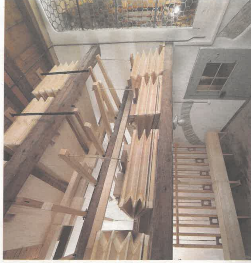
Die rekonstruierten Bossart'schen Balganlagen in Muri.
